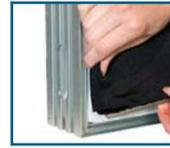
Im zweiten Schritt wird der schwarze Stoff in die äußere Profilmutter gesteckt.
